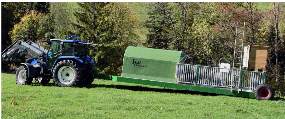
La porcherie mobile peut facilement être déplacée avec un tracteur, grâce à ses deux roues et à son dispositif d'attelage.
