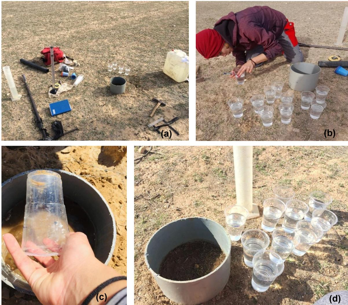
**Image 5: (a), (b), (c) and (d) illustrating steps of beerkan infiltration method**
