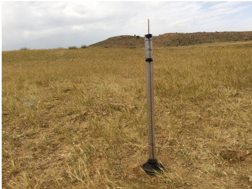
***Image 6: Mini-disc infiltrometer apparatus***
