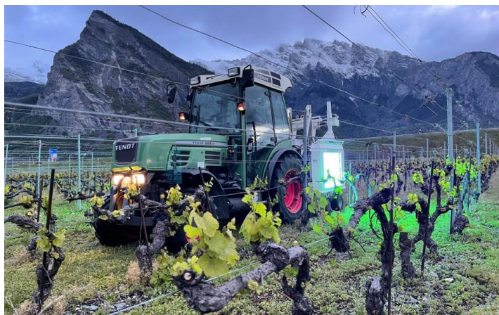
Figure 1 : Version professionnelle d'un système de traitement des vignes par flashes d'UV-C (UV Boosting).
