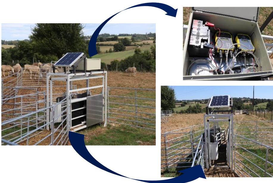
**Figure 4** : Prototype d'autopesée OtoP 3D
