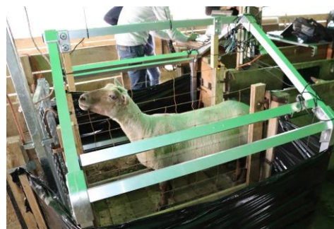
Figure 1 : Représentation schématique et photographie du prototype OtoP 3D pour estimer le poids des brebis de façon automatisée
