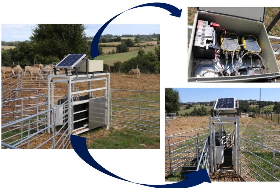
**Figure 4** : Prototype d'autopesée OtoP 3D
