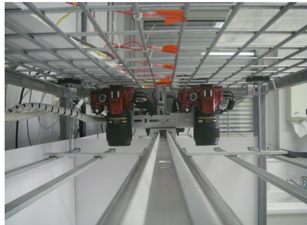
Figure 3. A : Photographie du chariot portant les appareils photo. B : Les éléments en rouges sur la grille correspondent aux capteurs de déplacement.
