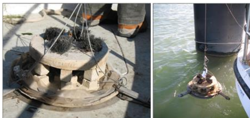
Photo 16 : Pose des substrats artificiels de type Verneaux - photos INRAE
