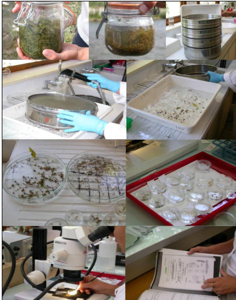
Photo 21 : Étapes de rinçage, tamisage et tri au laboratoire pour identifier et dénombrer les invertébrés. Photos G. Archambaud, INRAE.
