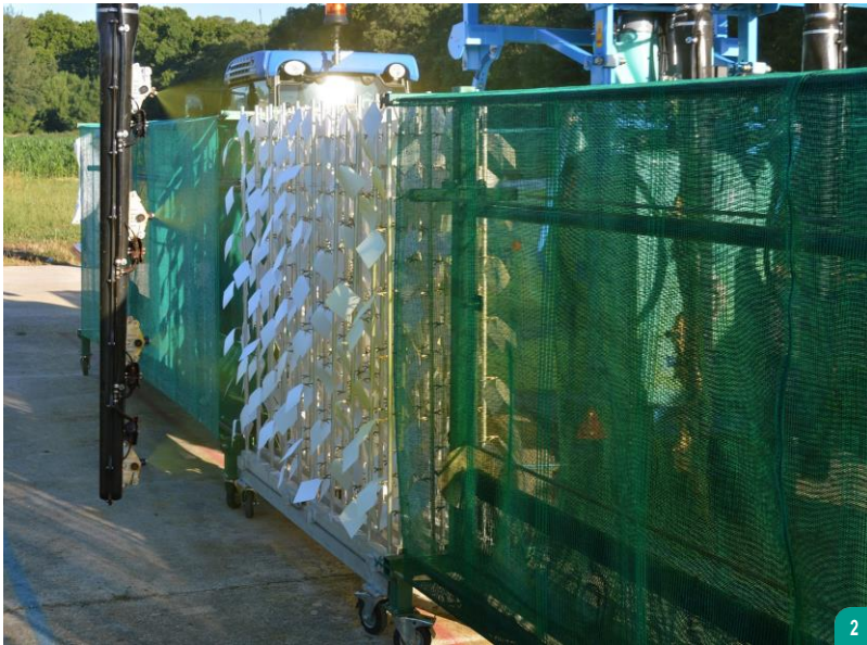
Entre 2014 et 2018, des dizaines de machines de différentes typologies (face par face, voûtes, aéroconvecteurs...) ont été testées sur EvaSprayViti selon la méthodologie développée par l'IFV et Inrae. Photo : IFV
