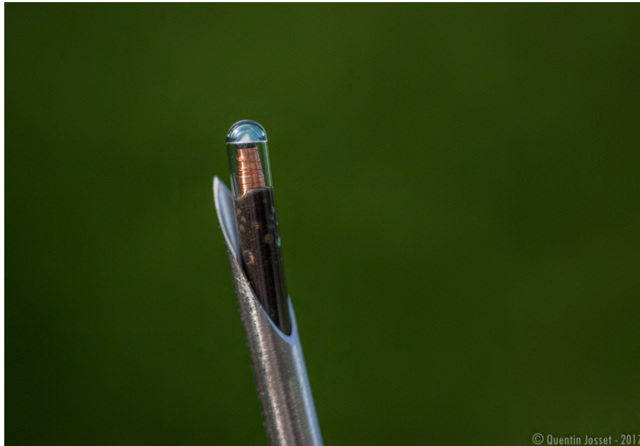
Figure V.3. Marque individuelle passive de type PIT-tag (12 mm).
