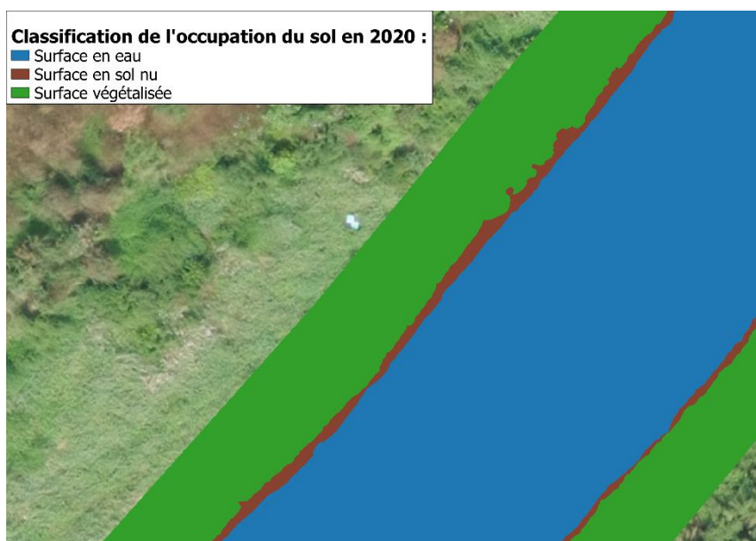
Figure 47. Exemple de cartographie de l'occupation du sol sur un site à partir des images ortho-rectifiées RVB
