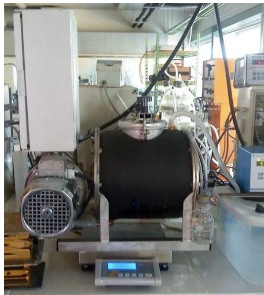
Figure 2 : Réacteur de 15 L en voie sèche (gauche) et vue schématique (droite).
