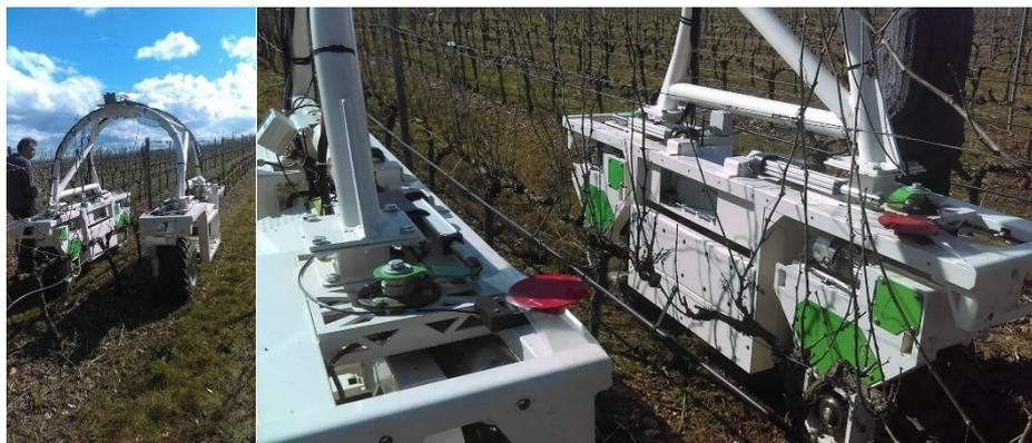
**Figure 8** : Montage et utilisation du capteur Physiocap® sur le robot Ted
