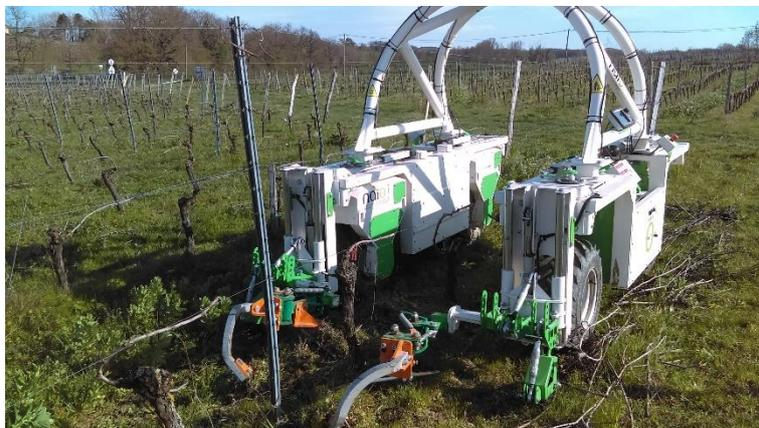
**Figure 1** : Robot viticole TED de Naïo Technologies
