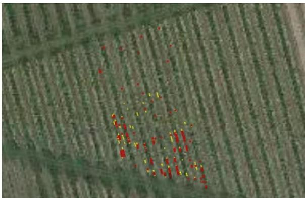
Figure 12 : Cartographie de la détection de la potentille obtenue avec le robot équipé des capteurs Carbon Bee
