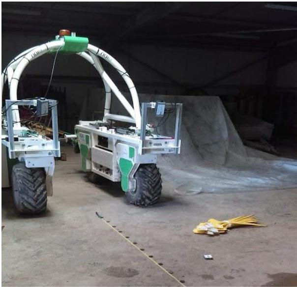
Figure 10 : Etape de paramétrage des capteurs Carbon Bee sur le robot
