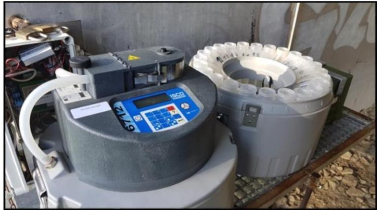
Figure 5 A gauche : préleveur réfrigéré à la station de Signy (aval) ; à droite : préleveur non réfrigéré à la station de Virey (amont).
