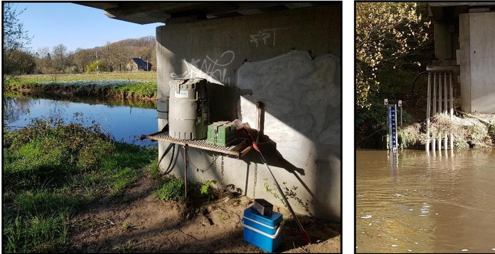
Figure 3 Station EDF-INRAE du pont de Virey à l'amont ; à gauche : préleveur automatique INRAE ; à droite : sondes EDF.
