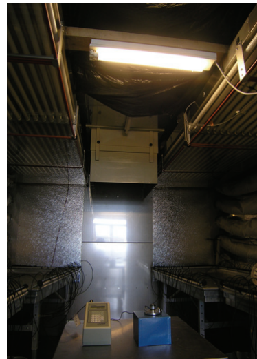
figure 25 : montage expérimental de mesure de l'éclairement d'une source étendue (tube fluorescent Philips PL-L 55W)
