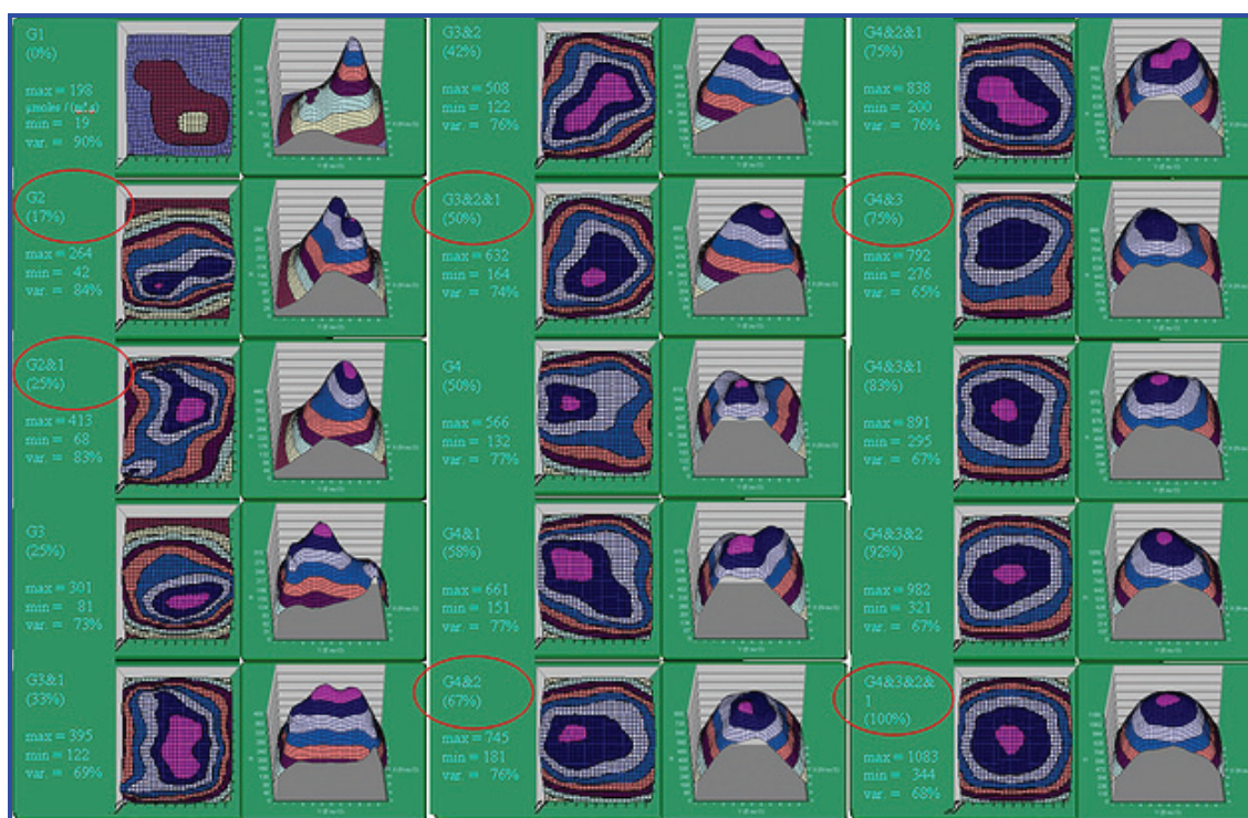
Figure 46 : distributions de l'éclairement énergétique PAR (en \mu\text{moles}/(\text{m}^2.\text{s}) ) dans la chambre A pour différentes consignes d'éclairage (prototypage)
