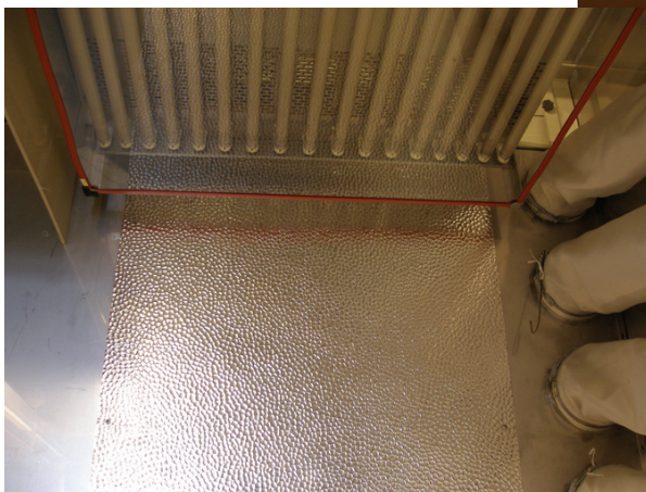
Figure 12 : vitre de protection située entre les tubes fluorescents et les plantes
