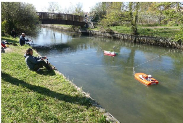
Figure 3. Quantification empirique des incertitudes des jaugeages ADCP par essais interlaboratoires : a) intercomparaison organisée par le Service de Prévision des Crues Grand-Delta sur la Sorgue (France) en avril 2022 ; b) graphique du logiciel QRAME montrant incertitudes élargies estimées par la méthode Oursin (barres d'erreur) pour chaque participant et en moyenne (en vert), et celle estimée empiriquement avec la méthode interlaboratoire pour l'ensemble des participants (lignes tiretées noires, avec l'incertitude de cette incertitude figurée par l'enveloppe grise). Le débit de référence (ligne tiretée rouge) est ici la moyenne des résultats de tous les participants. Les croix et les points sont respectivement les résultats de mesure obtenus directement via les logiciels de mesure des constructeurs et après post-traitement dans le logiciel QRevInt (noter l'amélioration sensible obtenue ainsi pour l'équipe S03_RR_RR07).
