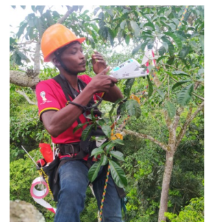
Boîte munie d'une résistance chauffante qui s'allume automatiquement afin de maintenir une température foliaire constante de +4 °C par rapport à une autre feuille de référence.
