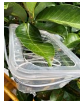
Boîte munie d'une résistance chauffante qui s'allume automatiquement afin de maintenir une température foliaire constante de +4 °C par rapport à une autre feuille de référence.
