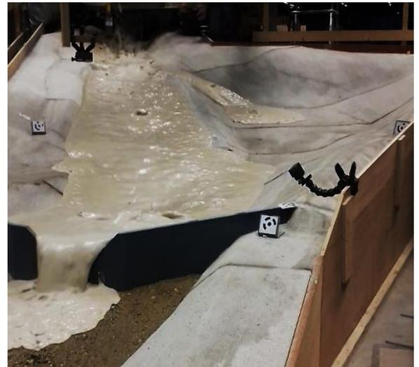
Figure 2 : Prises de vues lors d'un essai avec transport par charriage (gauche) et pour une lave torrentielle (droite).
