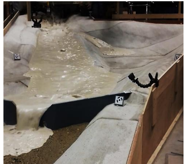
Figure 2 : Prises de vues lors d'un essai avec transport par charriage (gauche) et pour une lave torrentielle (droite).
