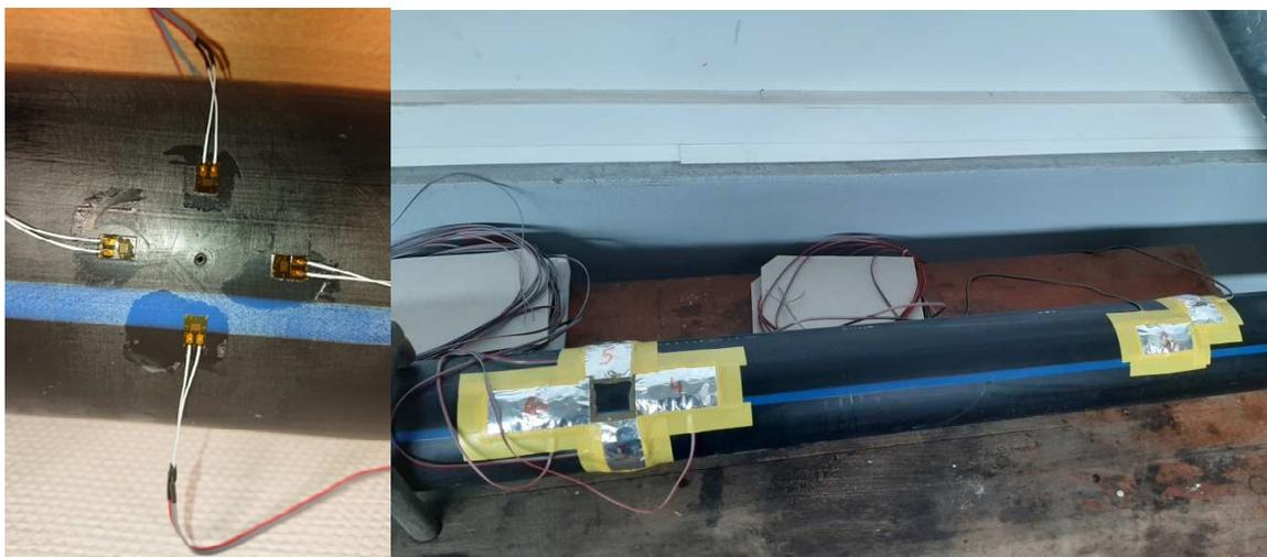
FIGURE 10 : JAUGES DE CONTRAINTE AVANT (A GAUCHE) ET APRES (A DROITE) IMPERMEABILISATION
