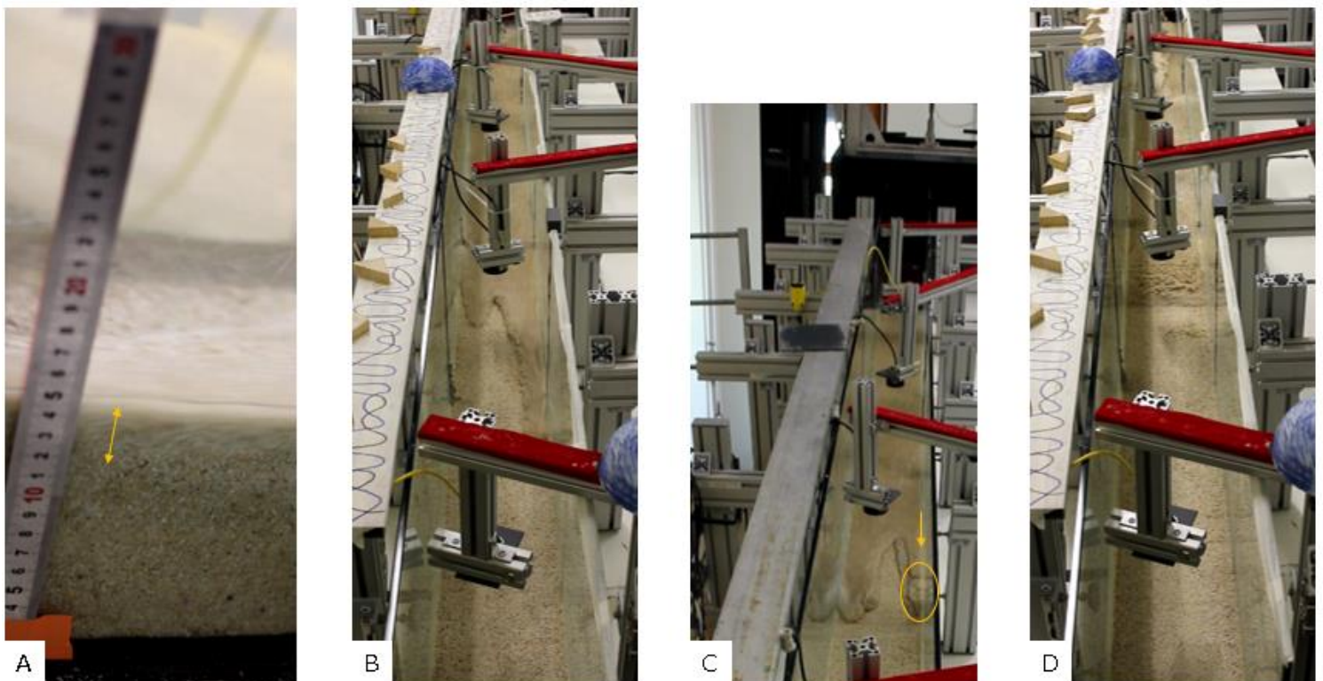
Figure 9 : Critère d'identification de la dynamique de l'écoulement A : 28.33 % - 20 L : Cisaillement du front sur 1,5 cm ; B : 22.71 % - 33L : Pulsé par l'amont ; C : 20.88 % - 26 L : Dépôt et reprise. Le cercle montre un dépôt qui va être repris par la vague indiquée par la flèche ; D : Dislocation du front
