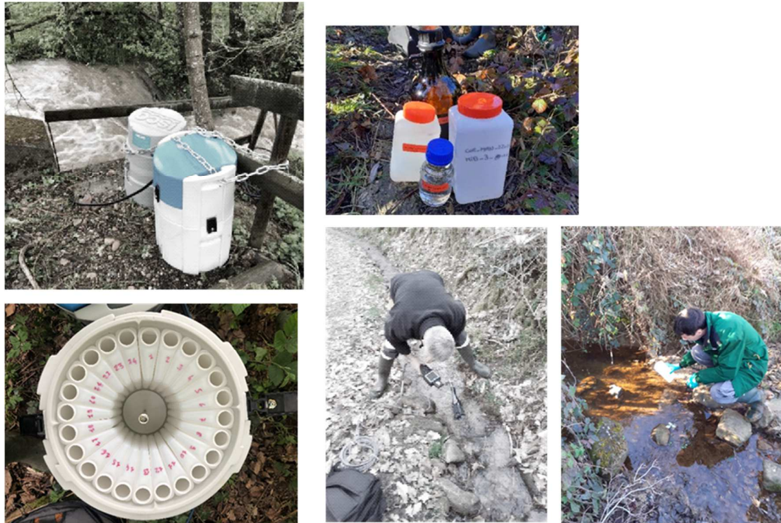
Figure 4 : Echantillonneur automatique sur la station du Mercier, mesures sur site et échantillonnage des sources sur le bassin de l'Yzeron/Ratier.
