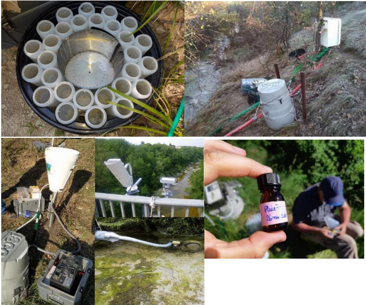
Figure 3 : (photos de gauche à droite et de haut en bas) : échantillonneur automatique, la station du Gazel, pluviomètre, radar sur la Claduègne/caméra sur le Gazel (mesure du débit), échantillonnage de la pluie. (source et info complémentaire : <https://ohmcv.osug.fr/Mesures-en-rivieres-Bassins-Oliviers-de-Serres>)
