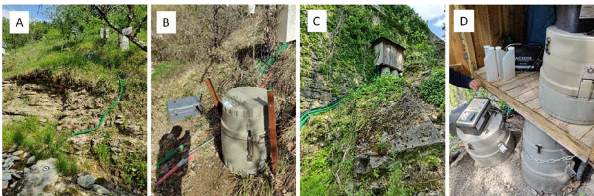
Figure 2 : Emplacement des préleveurs automatiques pour la collecte des échantillons de mélange sur la station débit du Gazel (photos A et B) située à proximité du lycée agricole du Pradel, et sur celle de la Claduègne (photos C et D) située à proximité de la commune de Villeneuve-de-Berg.
