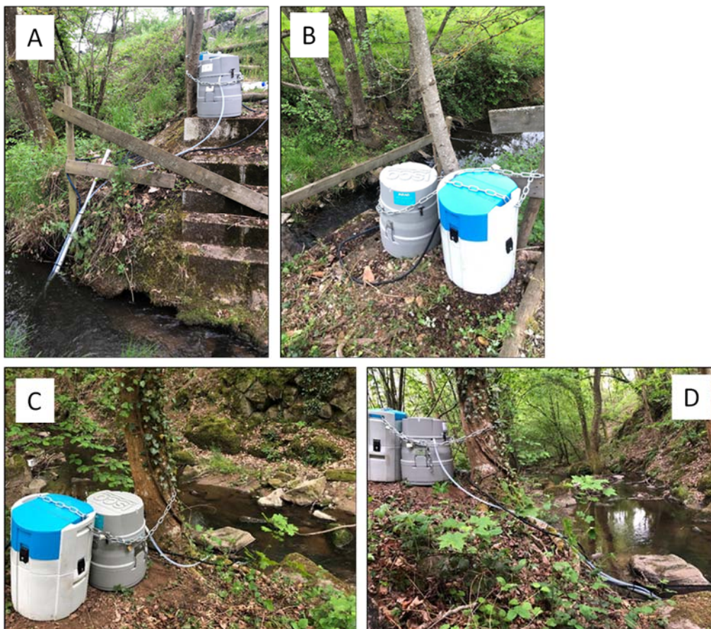
Figure 1 : Emplacement des préleveurs automatiques sur la station débit du Mercier au pont D640 (photos A et B) et emplacement des préleveurs sur la station débit du Ratier à Saint-Genis-les-Ollières (photos C et D), sur le bassin du Ratier / Yzeron.
