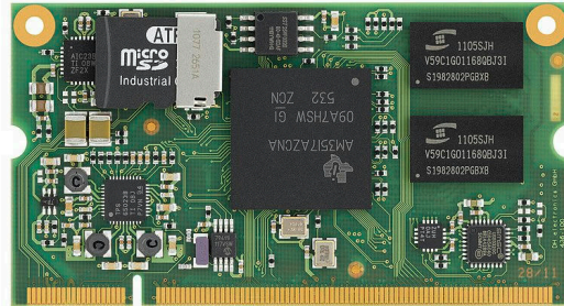
Fig. 1. – Carte d'extension avec système embarquée (Wikipedia Commons).
