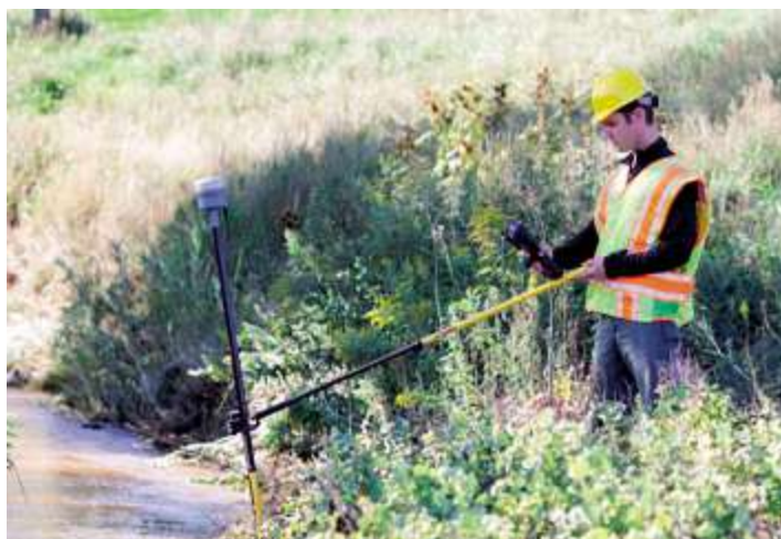
Figure 2. Utilisation du Trimble R10 à distance avec la canne inclinée.
