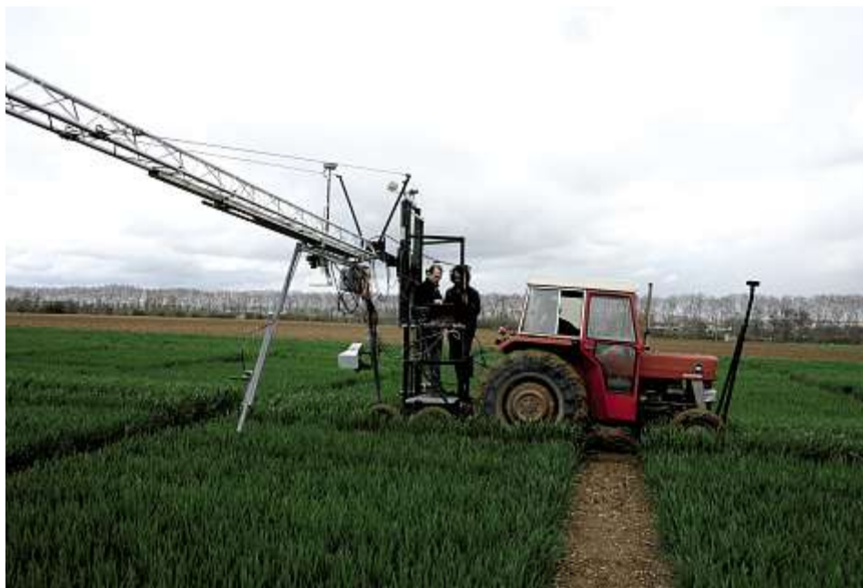
Figure 2. Vue du système en cours d'acquisition sur des microparcelles de blé (Photo P. Burger).
