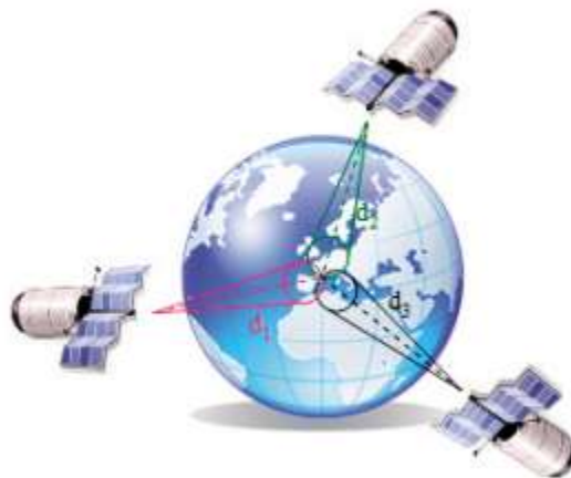
Figure 2. Principe de la triangulation pour géolocaliser un récepteur à la surface du globe. Un quatrième satellite permettra de définir l'altitude (Source : http://www.anr-prodige.com/index.php?n=Technologies.Geolocalisation )
