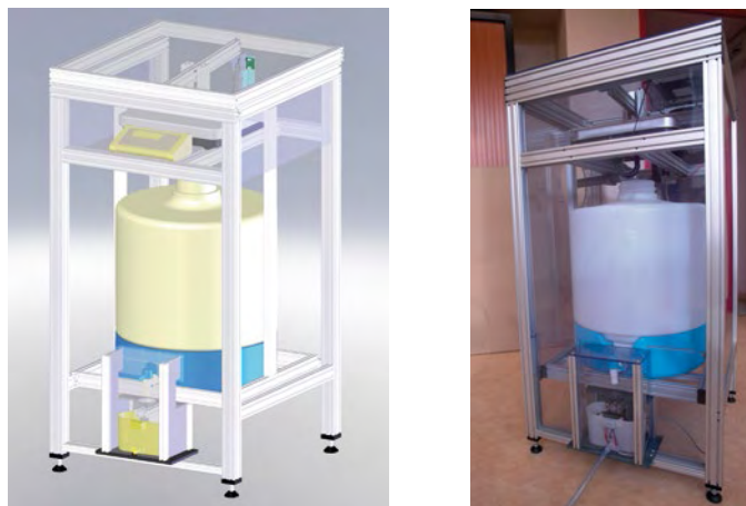
Figure 7. Photographies du projet Solidworks et du débitmètre terminé (photo : EMMAH).
