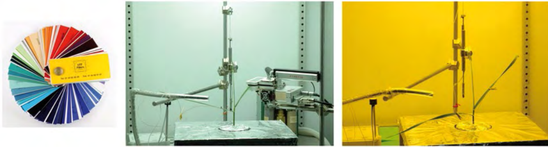
Figure 10. De gauche à droite : nuancier de filtres, enceinte de culture lampe HQI + HT 216, enceinte de culture lampe HQI + HT 015 (photo : S. Carre, INRA).
