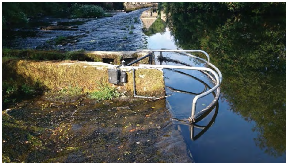
Figure 9. Passe à poisson du moulin de St Yves équipée d'une antenne (partie en aval du Scorff) (photo : U3E, INRA)
