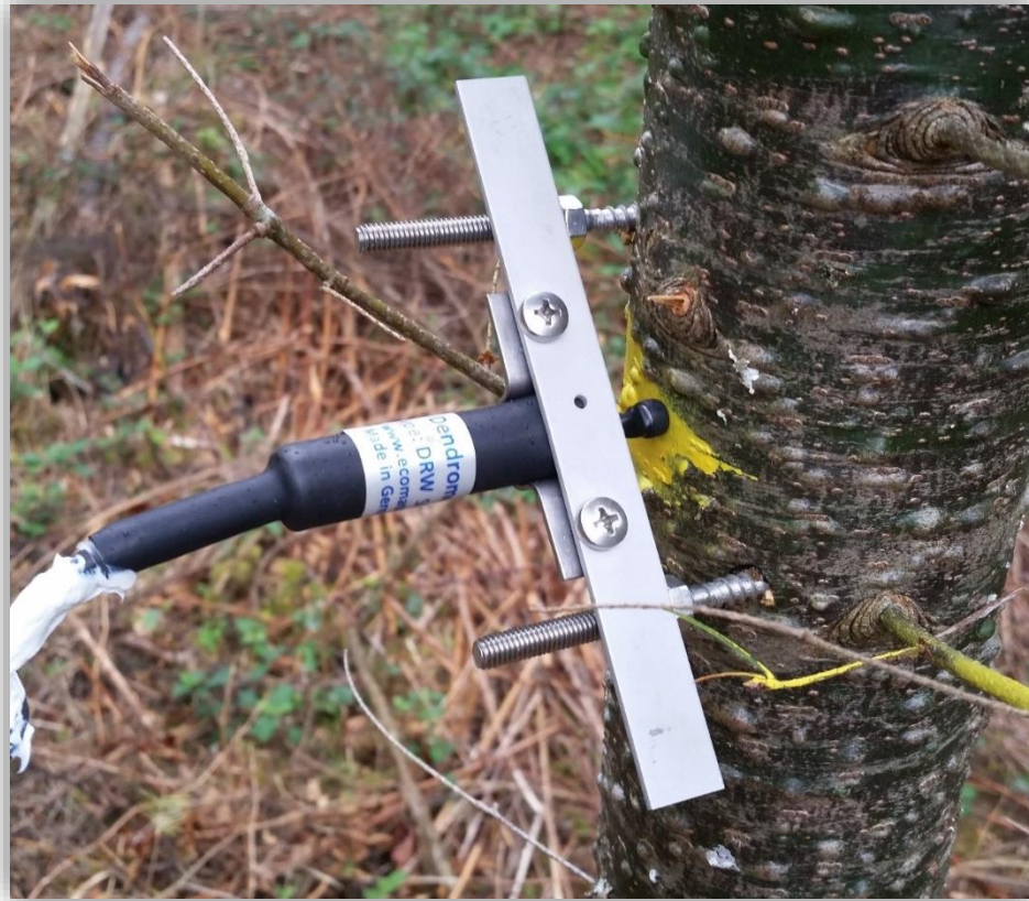
Dendromètre automatique à point, modèle DRW de la marque Ecomatik et utilisé dans le dispositif des Barres. Photo : Stéphane Matz.
