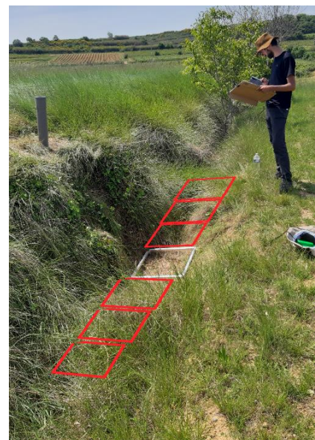
Figure 5 : Relevés floristiques sur les capteurs d'humidité, exemple d'un fossé Les carrés rouges correspondent aux futurs emplacements où le quadra (carré blanc) sera placé
