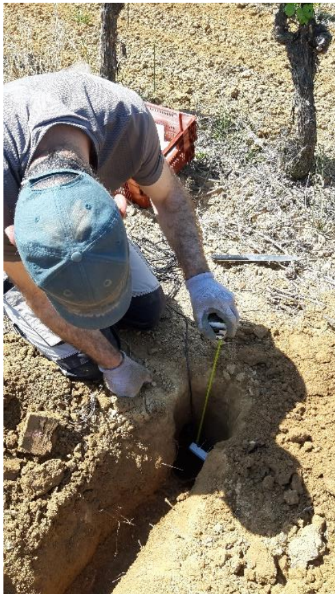
Pose des capteurs à 30 cm de profondeur
