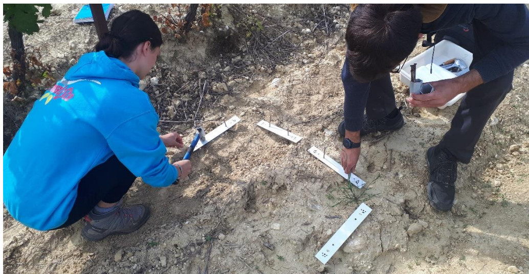
Annexe 11 : Pose des mires afin d'effectuer les photos pour le calcul de densité apparente par photogrammétrie
