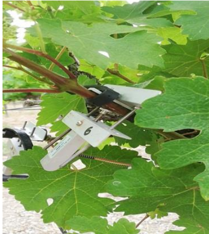
Figure 17 : Photographie de l'un des deux dendromètres du pied de vigne étudié (A. Fribault)
