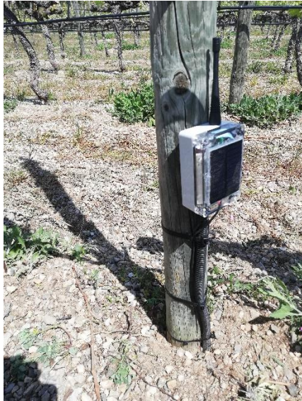
Figure 16 : Photographie du boîtier d'alimentation et de transmission de la sonde Terros 12 (A. Fribault)
