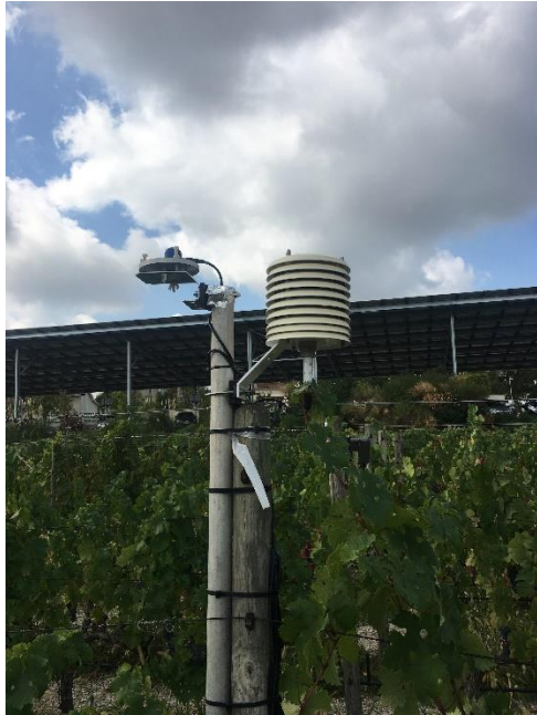
Figure 18 : Photographie de l'hygromètre et du pyranomètre sur le vignoble (A.Fribault)
