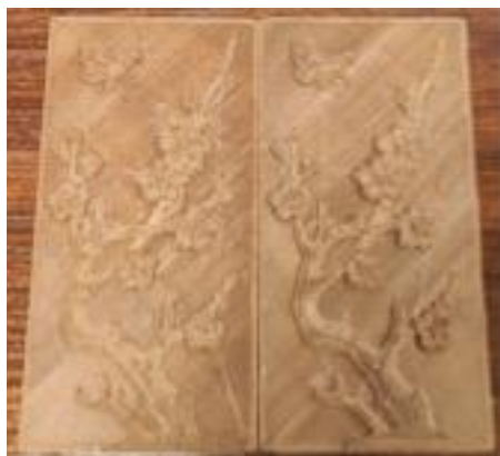
Fig. 4 : Motif de branche de cerisier imprimé en 3D (à gauche avec le composite PLA + MDF et à droite avec le composite PLA + MDF dépollué)
