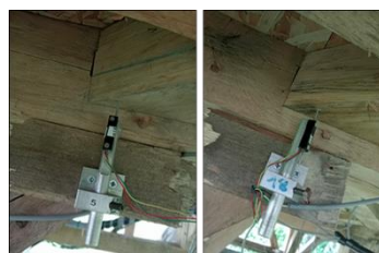
Fig. 6 : Déplacements verticaux enregistrés par les capteurs 05 et 18, positionnés aux extrémités des poutres de l'enrayure
