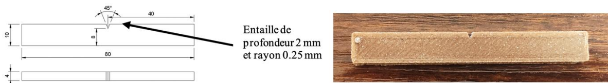
Fig. 1 : Plan et photographie d'une éprouvette de choc avant d'être cassée
