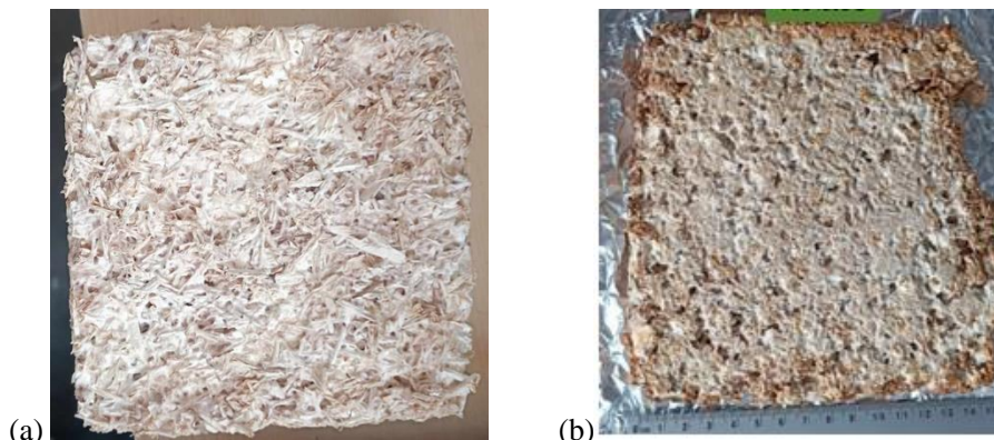
Fig. 3 : Observation visuelle des myco-composites fabriqués à partir de a) particules de hêtre et b) de coproduits d'usinage hêtre.
