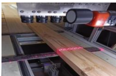
Fig. 3 : Scan du bois avec le Xyloprofil et mesure de la variation de la pente de fil (Rebhi et al 2023)
