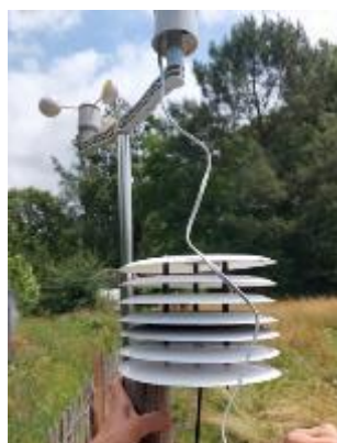
Fig. 2 : Capteur de température installé au sein d'un ensemble d'assiettes (protection solaire, convection) pour mesurer la température de l'air ambiant, associé à une station météo.
