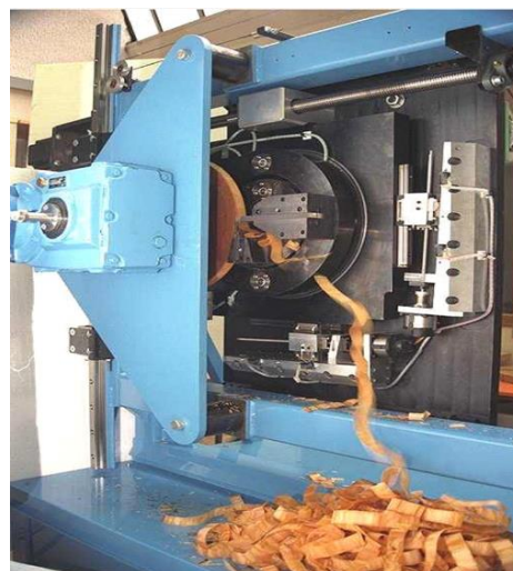
Fig. 2 : Micro-dérouleuse expérimentale, (J-C Butaud, 1996)
