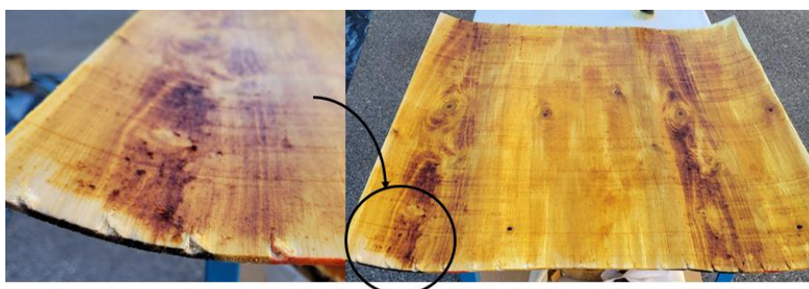
Fig. 5 : Application de la solution sur un placage. Mises en évidence de bandes de bois de tension
