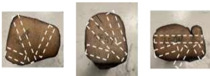
Fig. 2 : Illustration du plan de coupe des pièces à géométrie variable
