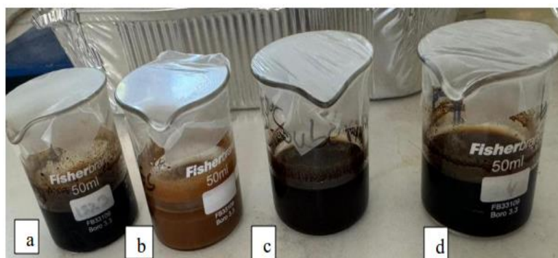
Fig. 1: Image représentative de lignine fonctionnalisée (silanisée) : (a) lignine seule ; (b) lignine-APTES ; (c) lignine-TEOS ; (d) lignine-1-HMDS
