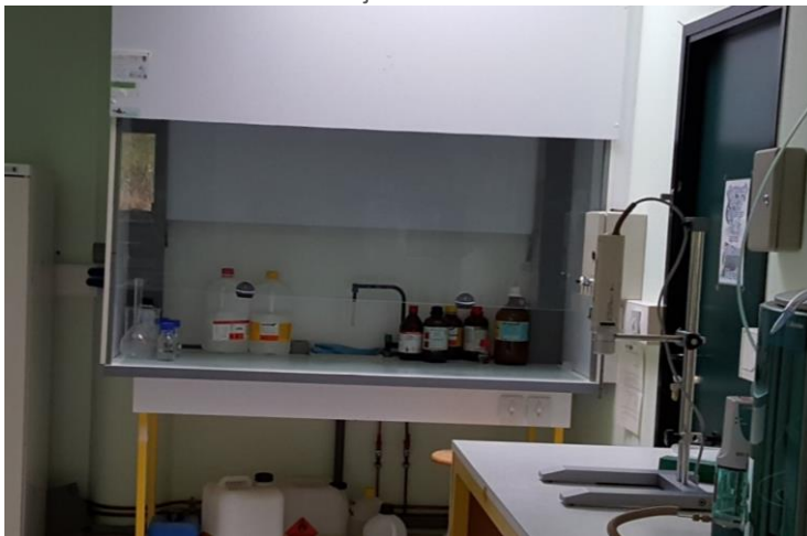
Hotte pour la manipulation de produits émettant des gaz nocifs pour l'homme
