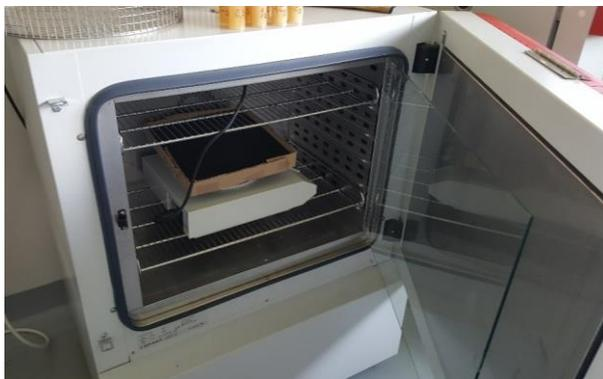
Etuve pour réchauffer la gélatine afin de mieux l'homogénéiser, les échantillons sont placés sur un plateau oscillant durant la chauffe il y a la présence d'un plateau mouvant pour homogénéiser pendant la chauffe
