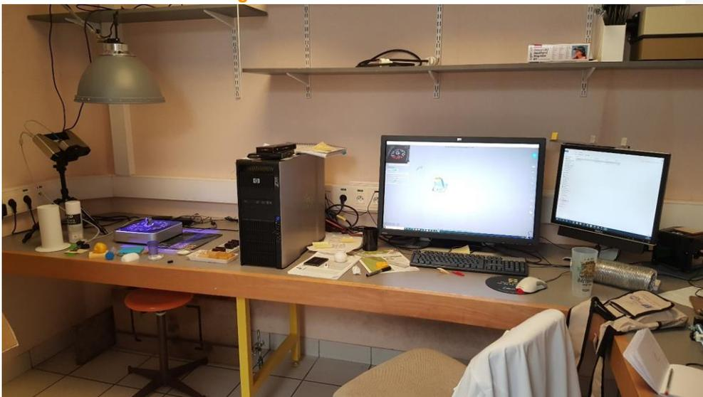
Poste de travail avec un ordinateur pour lancer les impressions et retravailler les pièces à imprimer. Cet ordinateur sert aussi à lancer l'acquisition de forme avec le scanner.
