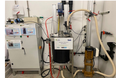
Réacteur tubulaire à ultrasons en mode batch avec circulation du milieu
