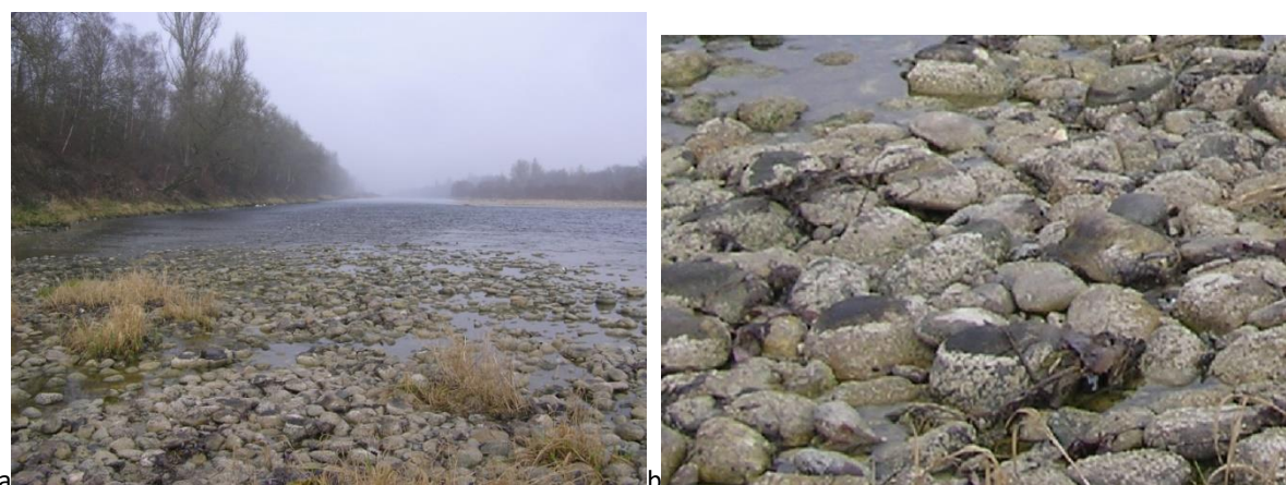
Figure 50 : (a) (b zoom) exemple de pavage sur le Vieux Rhin indiqué par la présence d'une croûte de biofilm ancienne et l'absence de tuilage alors que d'autres bancs en présentent dans le même secteur.
