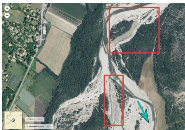
Figure 100 : exemple d'ouverture de chenaux secondaires sur le Buech à Mison (04)
