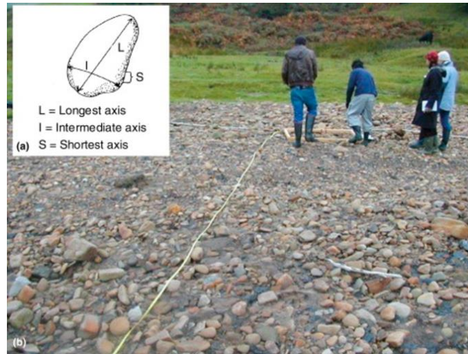
Figure 54 : mesures « Wolman » le long d'un décimètre
