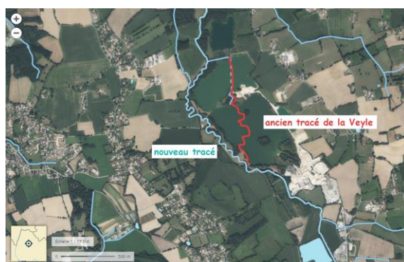
Figure 84 : le nouveau tracé de la Veyle (01), creusé intégralement dans le lit majeur en 2009 pour « sortir » le cours d'eau d'une gigantesque gravière qui avait été réalisée sur son cours et au-delà.
