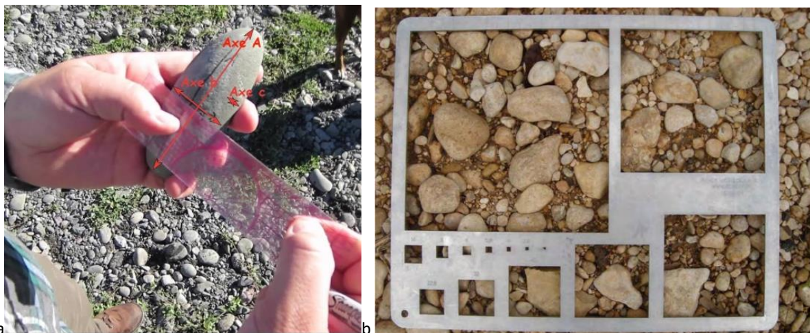
Figure 55 : a) mesure à la règle de l'axe b d'un galet, b) granulomètre
