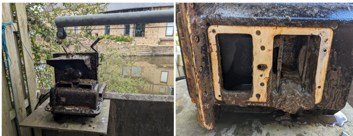
Figure 29: Accumulation de sédiments fins sur la DIDSON (à gauche) et dans le boîtier des lentilles de la caméra DIDSON (à droite), en août 2023. © INRAE
