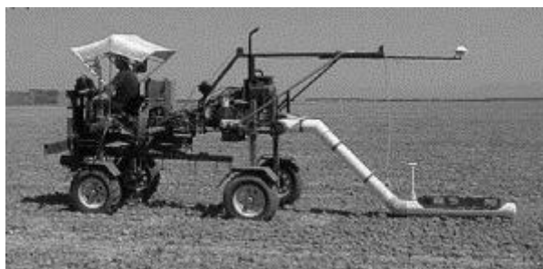
Figure 13-5. Dispositif tracté de mesure de la conductivité électrique apparente par un conductimètre Geonics EM38 (d'après Corwin et Lesch, 2005b)
