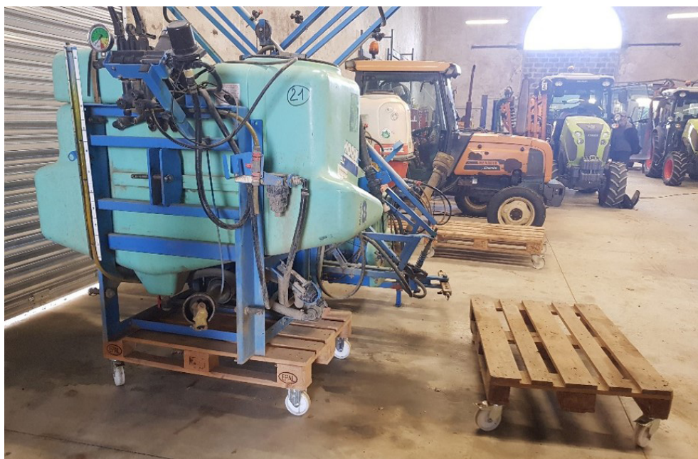
Figure 1. Illustration d'un système auto-fabriqués à partir de palettes et de roulettes.
