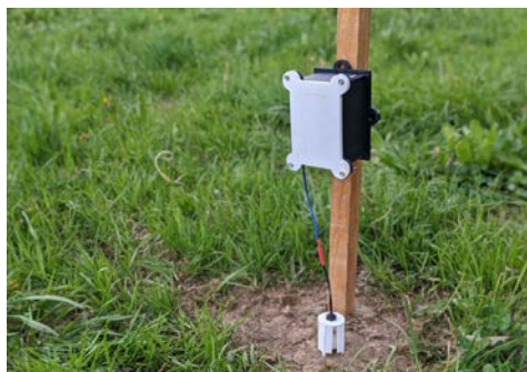
Figure 4. Illustration d'un PillowTech : un flotteur est positionné au niveau de la terre.
