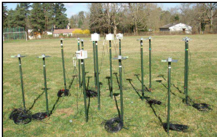
Photo 2. Etalonnage des capteurs : au début de la saison de terrain, tous les capteurs qui seront utilisés pendant la campagne de mesure sont installés en terrain découvert pour corriger d'éventuelles différences entre capteurs. L'un des capteurs sert ainsi de référence et un coefficient de correction est appliqué à chacun des autres capteurs.
