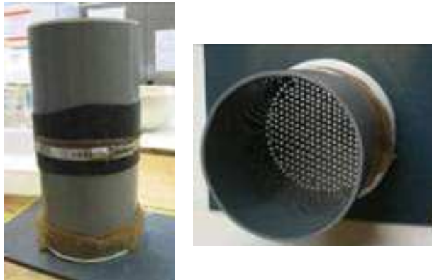
Figure 2.3 : Assemblage des cylindres et plaque de support
