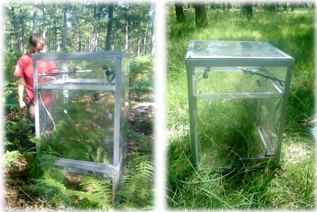
Photo 7 : Illustration de la chambre de transpiration sans la rallonge pour les mesures d'évapotranspiration de la molinie (droite) et avec la rallonge pour la fougère aigle (gauche)
