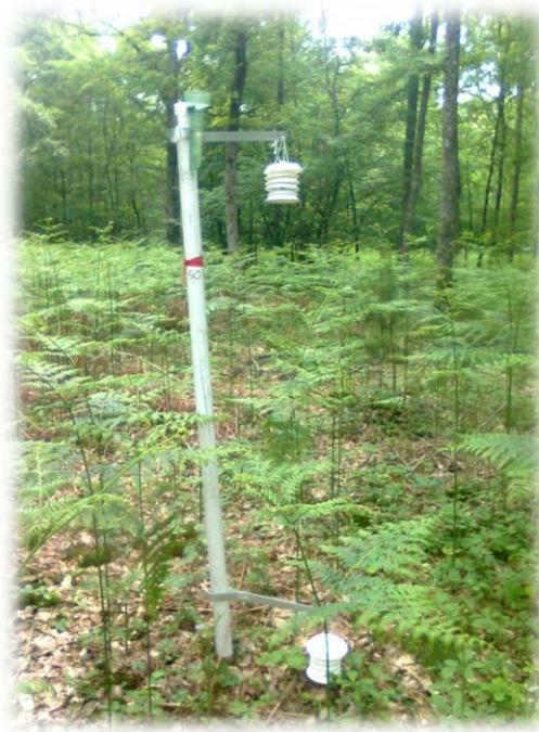
Photo 8 : Illustration d'un point de mesure sur une placette enherbée en fougère aigle avec un pluviomètre et un abri météo installé à 2 m
