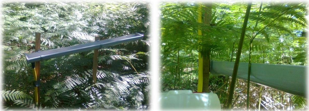
Photo 9 : Illustration de la mesure de l'interception de la pluie par la fougère aigle à l'aide gouttières au-dessus (gauche) et une seconde en dessous (droite) de la canopée des frondes
