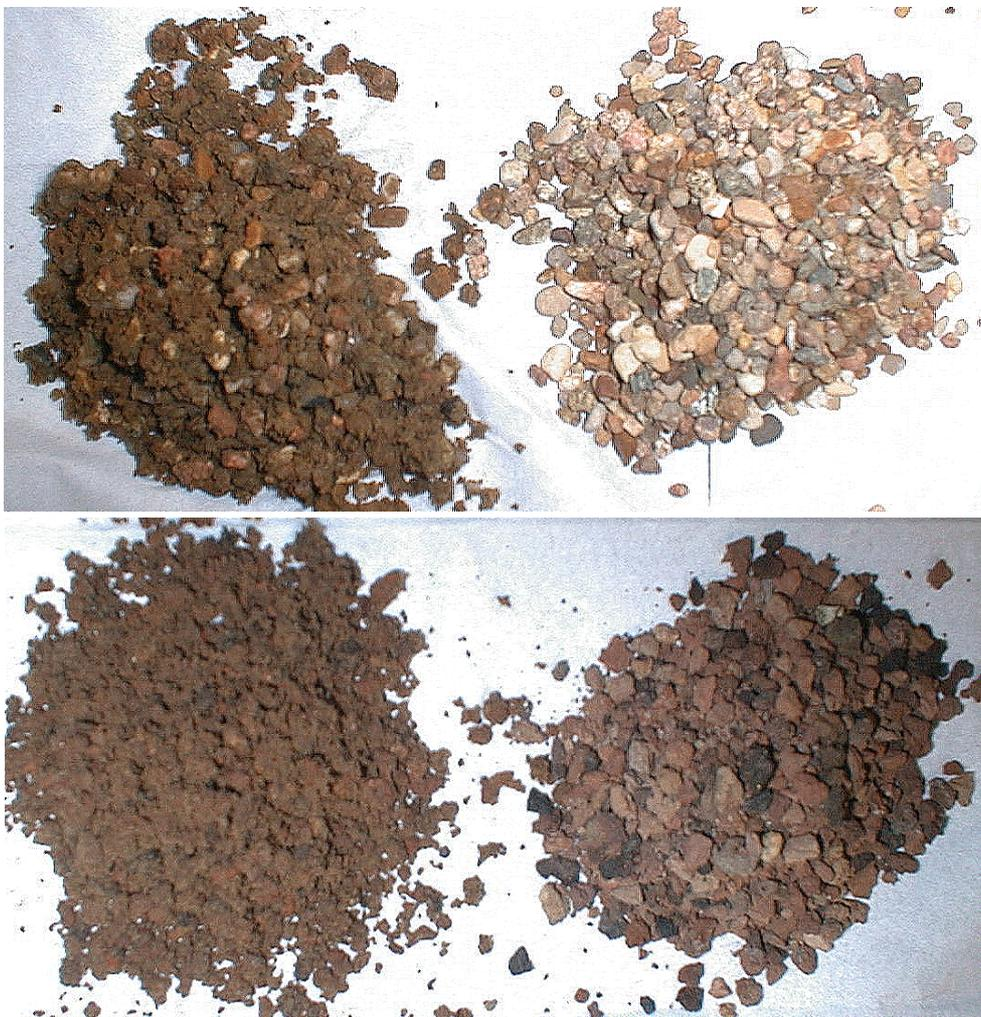
Figure 52. Gravier (en haut) et pouzzolane avant et après utilisation dans les colonnes G1 et P1 (support vierge à droite)
