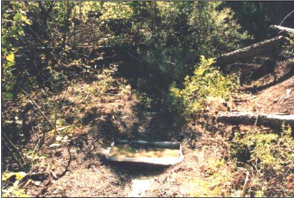
Photo 34 : Piège à sédiments de la ravine I avant la pluie du 20-21 Septembre 2000
