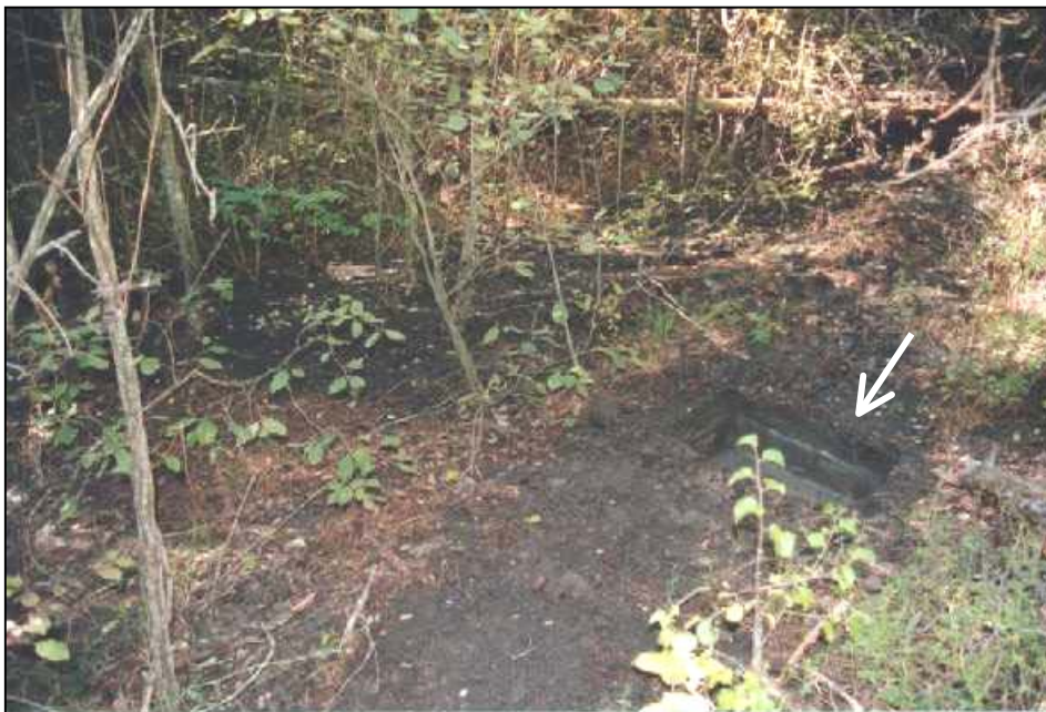
Photo 35 : Après la pluie du 20-21 Septembre 2000, le piège a disparu sous plusieurs centimètres de dépôts
