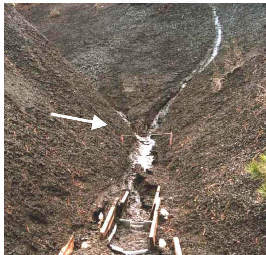
Photo 7 : Dispositif de mesure des transects transversaux dans les ravines, utilisé par Ollivier et Pinatel (2000)
