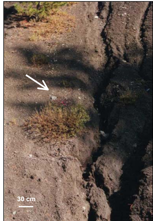
Photo 13 : Creusement de rigoles sur versant après un orage ; les sédiments peints (E3) ont peu bougé
