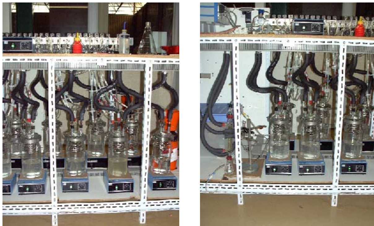
Figure III-5 : Vue d'ensemble du banc de mesure de la biodégradabilité par test de Sturm
