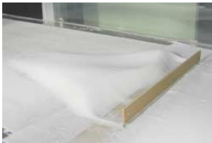
Photographie 31 : dépôt derrière la barrière à neige, soufflerie du C.E.S., au Japon.
