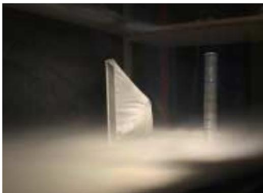
Photographie 15 : filet et capteur acoustique de particules.
