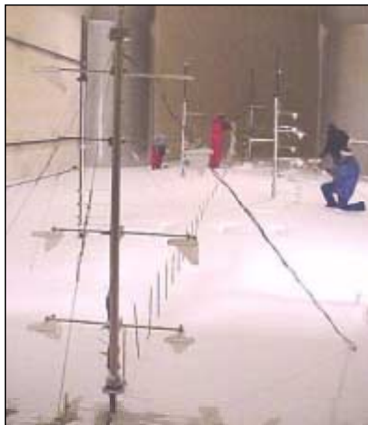
Photographie 28 : capteurs mécaniques (filets à papillons) servant à mesurer les débits de neige transportée.
