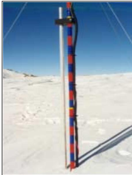
*Photographie 27: le capteur acoustique de transport.*
