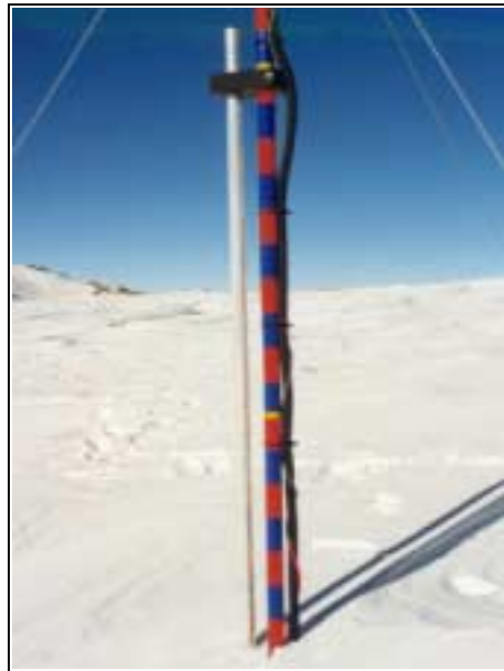
Photographie 27: le capteur acoustique de transport.
