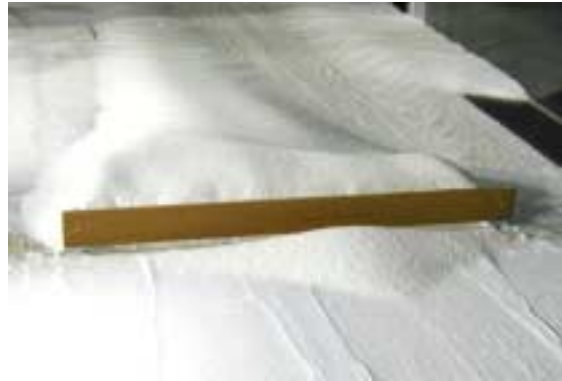
Photographie 32 : dépôt autour d'une barrière à neige. Expérience avec la neige type grains fins.
