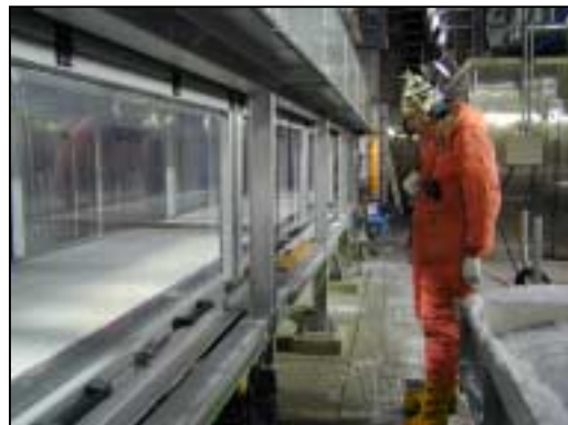
Photographie 21 : veine d'essai de la soufflerie de Shinjo.
