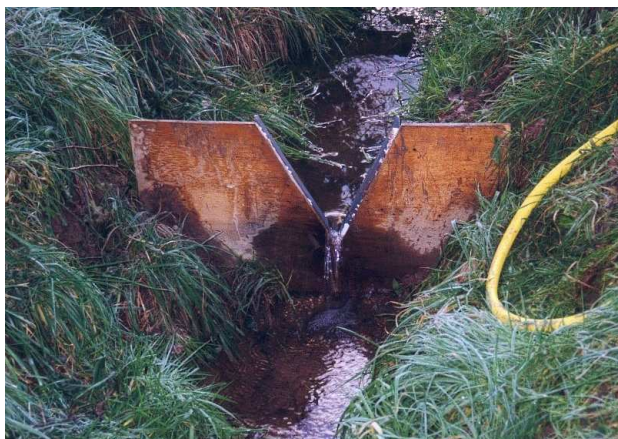
Photo B-3 : seuil utilisé pour la mesure de débit
