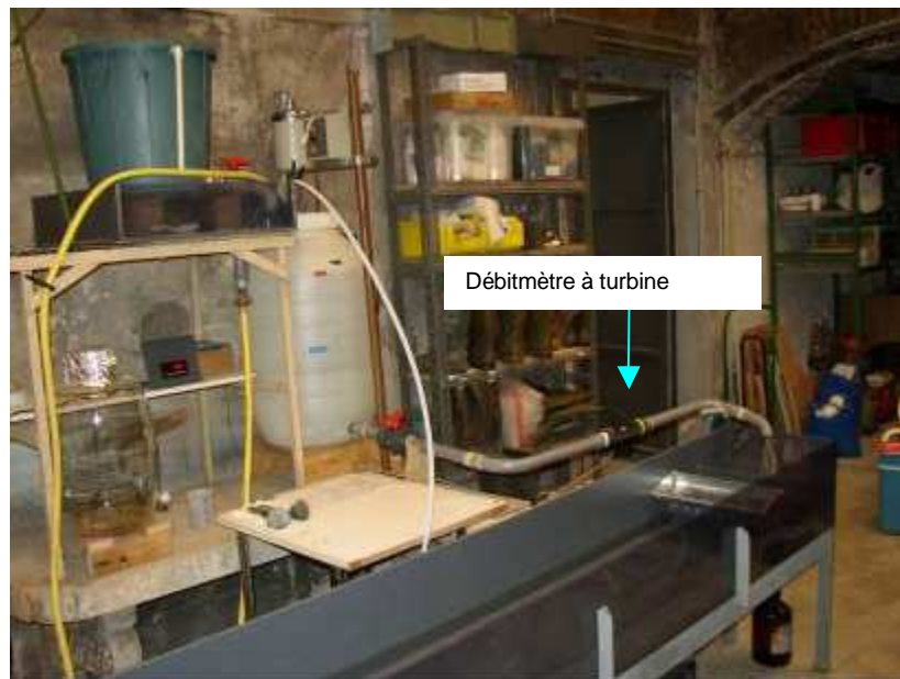
Mesure de débit à l'entrée du canal
