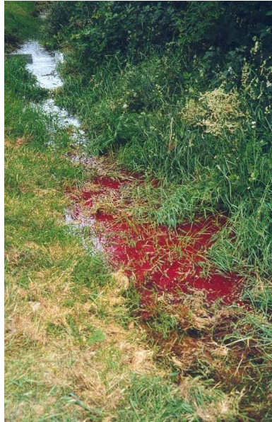
Photo B-4 : application de la méthode de dilution (rhodamine WT) pour l'estimation du débit des fossés
