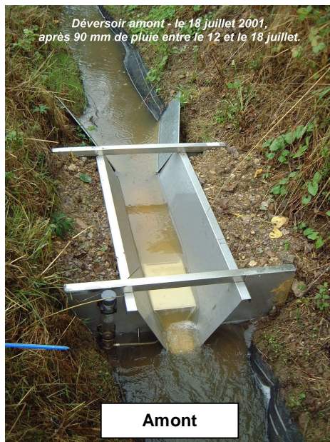
Photo B-5 : venturi amont et aval sur le fossé CORAUX
