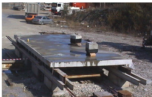
Fig. IV. 1 – Maquette horizontale de la dalle PSD (PBR)
