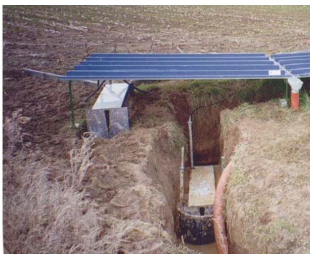
Figure II-11 : Image des systèmes de mesures des débits drainé et ruisselé et du toit du fossé.
