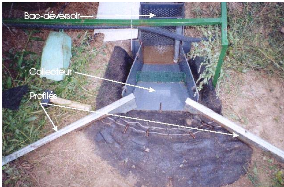
Figure II-14 : Collecteur du ruissellement et les profilés qui captent l'eau ruisselée.
