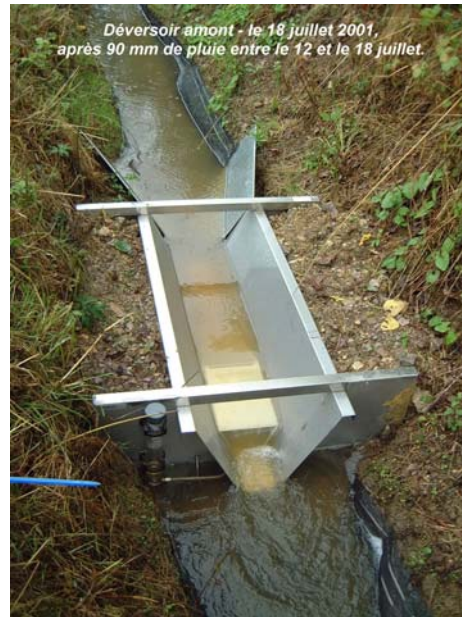
Figure II-32 : Canal jaugeur amont
