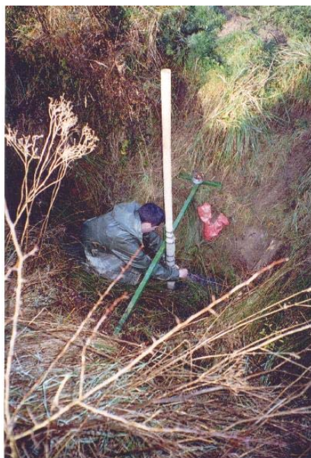
Figure II-17: Système de mesure du niveau d'eau dans le ruisseau
