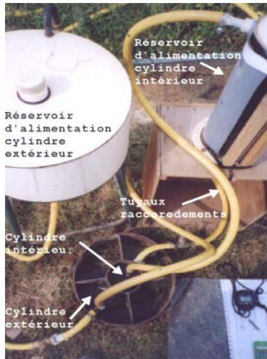
Figure II-18: Infiltromètre à double cylindre
